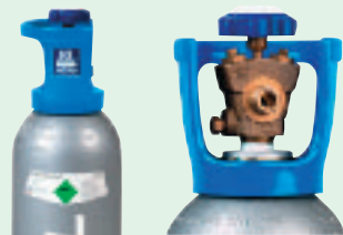
Flaskeventil DIN 477 nr 6 for flaskestrykk på 50 bar ved 15 °C. Transport kode ADR klasse 2.
