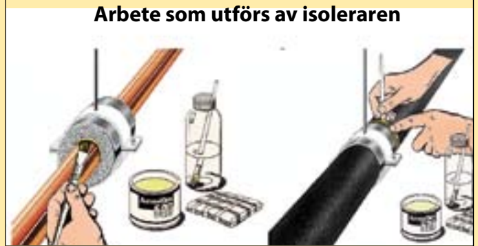
Fig 8: Armafix rörskål installeras i två steg – rörskålen monteras av rörin-stallatören och därefter utför isoleraren den angränsande hopfogningen
