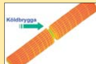
Fig 3: Diagrammet visar på tydliga värmeförluster ("köla") i området kring rörupphänget
