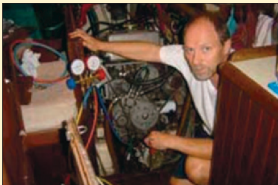
Kompressoren er en vanlig bil-aircondition kompressor. Kondensatoren er en varmeveksler på kjørevannet på motoren og fordampere av akkumulator typen.
