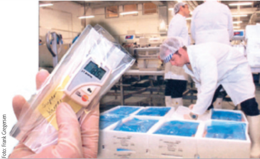
Dette er et termometer som kontinuerlig måler og registrerer temperaturen under transporten. Slike fulgte med i fisekassene og utenpå pallene fra Hammerfest.
