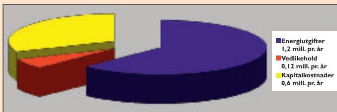
Årlige kostnader for et kuldeanlegg.
