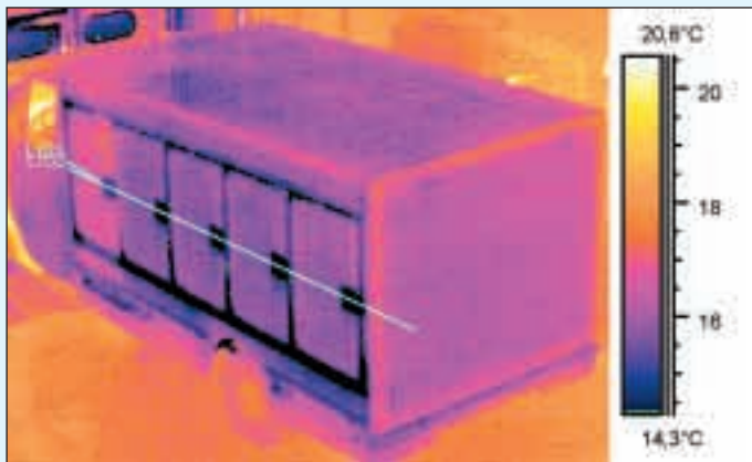
Termografi af kølekasse fra en "Hjem-IS" bil. Billedet viser, at kølekassen er godt iso-leret. Det er ikke overraskende, at der er mindre kuldebroer omkring døre og håndtag.
