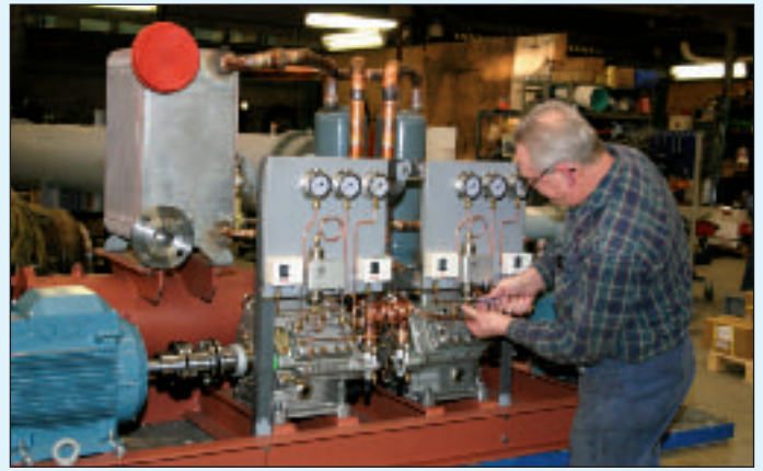
Magne Johannessen arbeider på kjøleanlegg for proviant til en MTB båt hvor det er strenge krav til vekt.
