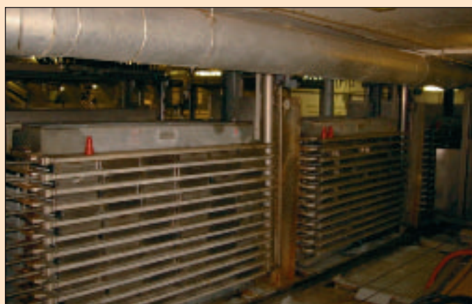
Horisontale platefrysere for mindre 7 kg blokker med f.eks reker.
