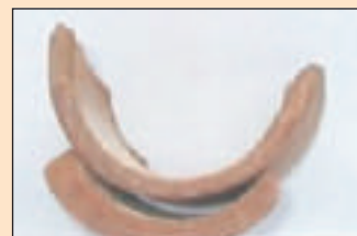
Tre mm beläggning på 25 mm kondensorrör från SydSverige efter ca 6 års drift utan vattenbehandling.
