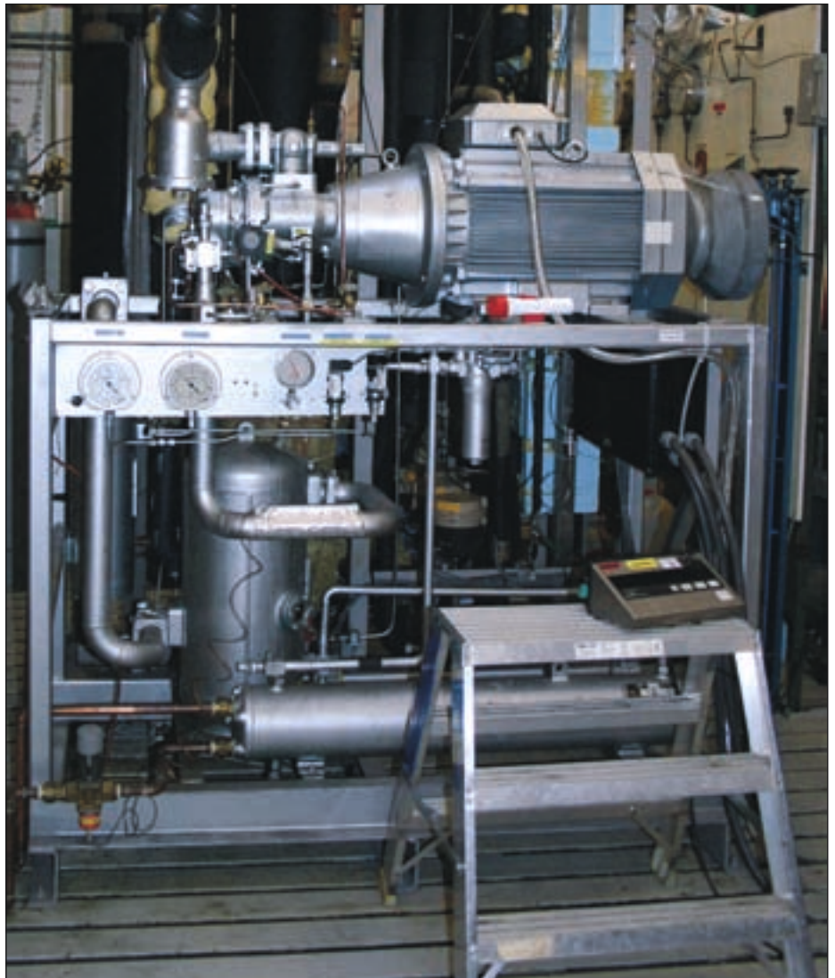
Det er sterk interesse for slike småskala anlegg som kan revolusjonere bruken av LNG. Laboratorieranlegget har gått i 1000 timer uten noen store problemer.
