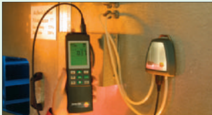
Testos nye 521 og 526 referencetrykinstrumenter har indbygget differensstryksensor og kan samtidig tilkobles en eller to eksterne sensorer til andre måleområder eller måleparametre.
