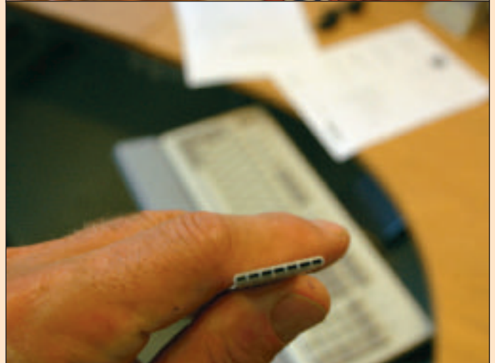
Primal Fernando arbeider med utvikling av varmeveksler med meget små kanaler som blant an-net er meget aktuelt i forbindelse med overgangen til CO 2 som kuldemedium.
