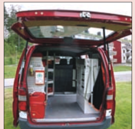
Det er viktig at utstyret festes skikkelig slik at det ikke løsner under kjøring eller kollisjoner.
