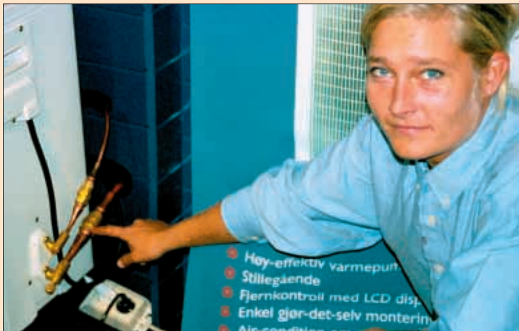
"Gjør det selv" - prinsippet er basert på at rørforbindelsene er ferdig fylt med kuldemedium fra fabrikk. Ved monteringen punkteres rørene automatisk slik at gassen kan strømme fritt mellom innedelen og utedelen sier Kari-Anne Bredesen.
