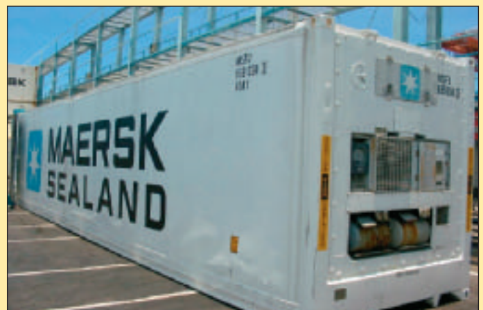
Fig 1 I dag tilbys ref. containere (Maersk Sealand) som klarer -35 og -60 grader Celsius, og også containere for innfrysing på -60 Celsius.
