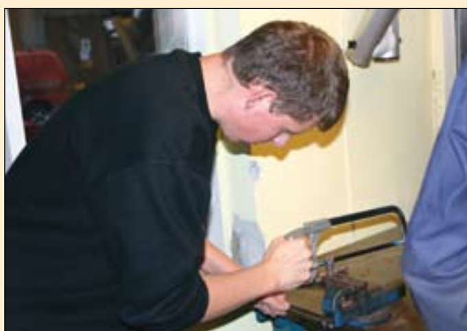
2) så splitter man røret på langs og bender det ut. vist av Stig Andre Brakstad.
