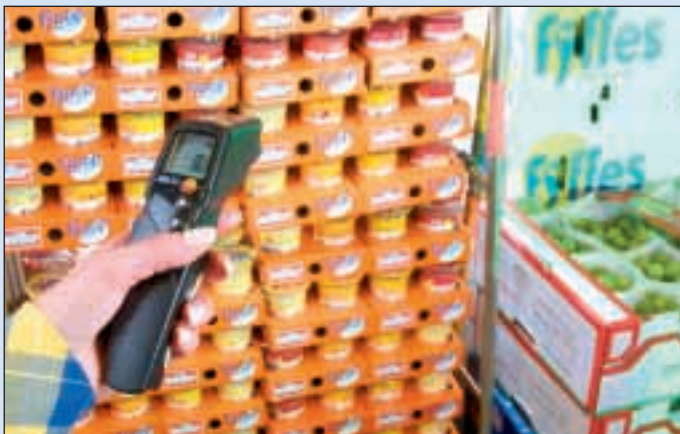
T830-laserpistolen ligger godt i hånden og laver hurtige, præcise temperaturmålinger, fx ved indgangskontrol af fødevarer.
