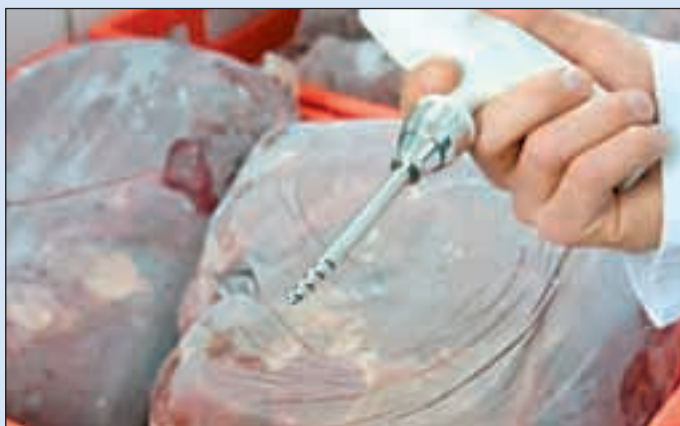
Testos nye T105 indstiks-termometer ligger godt i hånden og har et opadvendt display og letbetjente knapper.
