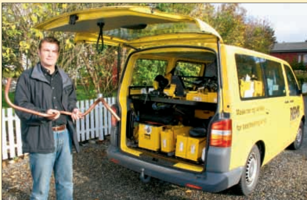
En av Rems demonstrasjonsbiler for verktøy. Her viser Otto Sekboskar et eksempel på hvordan man enkelt kan bøye kobberør opp til 35mm og uten skjøter.
