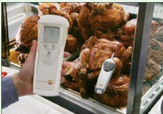
De trådløse følere kan aflæses fra en rækkevidde op til 20 meter.
