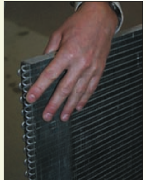
Ved innføring av CO 2 -systemer for biler var det også nødvendig å utvikle nye varmevekslere med trange kanaler. De er nå satt i produksjon av Norsk Hydro. Dette er den håndlagede prototypen.
