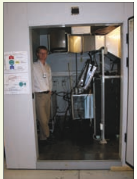
Prøverommet for varmepumper for utvikling av nye CO 2 -kompressorer for varmepumper som har bedre effekt ved lave temperaturer for dermed å øke varmemytelsen. Arne Jacobsen.
