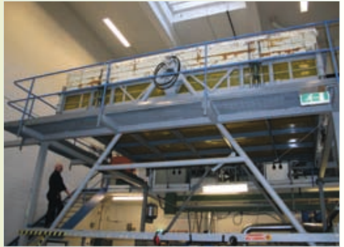
Anlegget for utprøving og forsøk av varmetransmisjon og isolasjonsprøver ned til minus 164 grader Celsius i større skala. Forsøkene kan foretas både horisontalt og vertikalt. Ketil Larsen.
