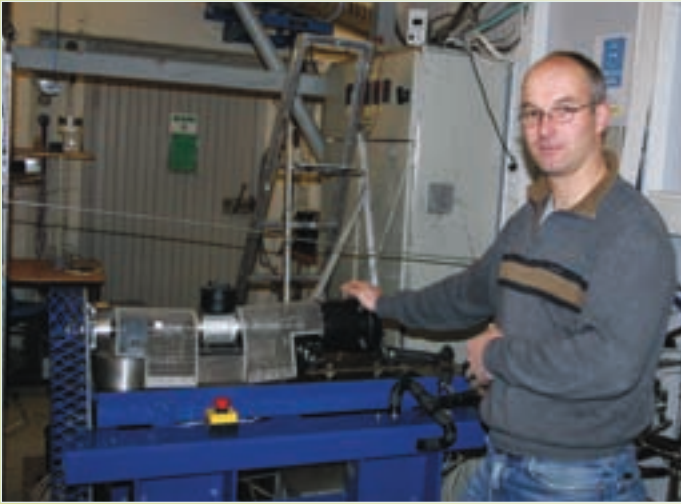
Testanlegg for CO 2 varmepumper til bil. Armin Hefner.
