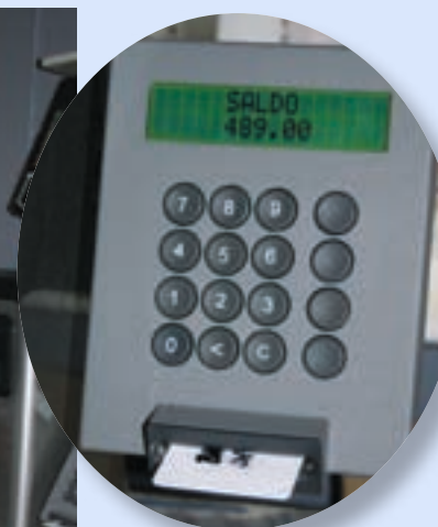
Kortleseren som er montert på drikkevannskjøleren gjør det mulig å ta seg betalt for det vannet turistene forsyner seg med.
