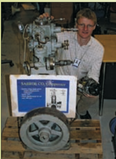
Arne Jacobsen viste frem en dobbeltvirkende CO 2 -kompressor fra Sabroe fra 1927 med et turtall på 300 omdr/min. En moderne kompressor med samme kapasitet ville bare ha et volum på 61 cm 3 .
