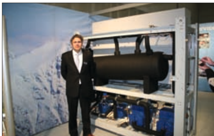
Teknisk sjef Frank Wold-Pettersen viste frem Carriers et transkritisk CO 2 -anlegg og mente at dette er fremtiden for dagligvarehandelen.
