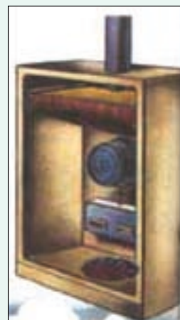
Tegningen viser et aspirasjonsanlegg som suger luft gjennom rør i bygningene. Luften ender i et røyksugeskap hvor en røykdetektor sitter.
