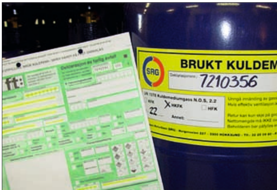
Deklarasjonsnummer påføres beholderen på denne måten. Gule flaskemerker kan bestilles hos SRG.
