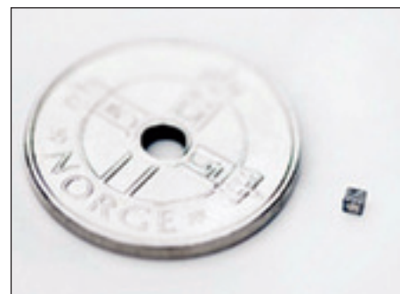
Så liten: Til høyre på bildet ligger en miniatyrvarmpumpe. Den er en kubikkmillimeter stor.
