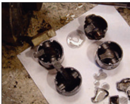
Kølemiddeldampen begynder nu at kondensere i kompressoren, og krumtaphusolien fortyndes langsomt med kølemiddelvæske.
