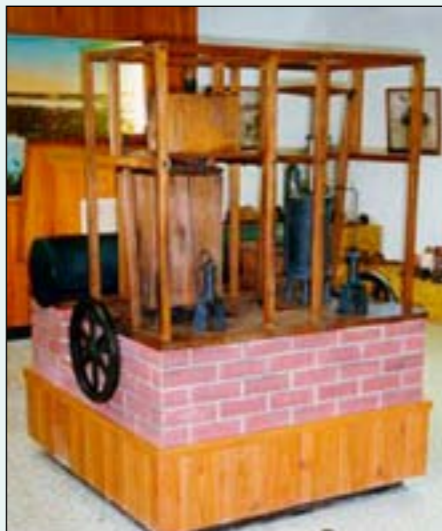
Modellen av den originale ismaskinen i Gorrie Museum i Florida. Isboksen er plassert øverst.
