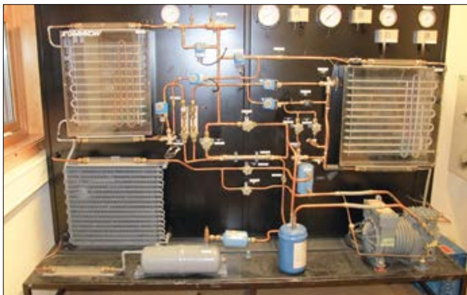
Laboratorieoppgaver i kuldeteknikk foregår på denne delikate riggen.
