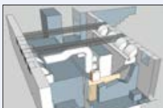
Innredning i kjeller med varmepumpen midt i bildet. Inntakskanaler til høyre, avkast til venstre. Det ble benyttet eksisterende åpninger i kjeller-veggene.
