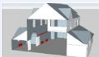
Plassering av radiatorer og varmeliste i interiøret. Varmelisten ble montert for å hindre kaldras på personer som sitter inntil denne veggen. Øvre del av veggen er yttervegg og med minimal eller ingen isolasjon.
