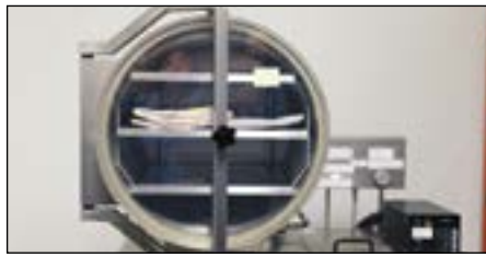
Vakuumpører ut frosne vasskrystallar. Når prosessen er ferdig, er bøkene tørre.
