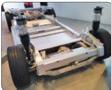
Ovenstående viser undervognen på en Tesla S P90D. I den nye model P100D har Tesla formået at få plads til 10 kWh ekstra batterikapacitet. Det er sket ved at pakke batterierne tættere og øge kølingen.
