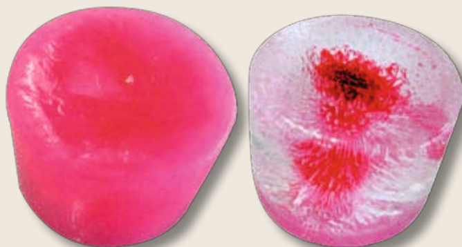
Til venstre en CAS-frossen væske med noe rød mat som holder en jevn struktur. Til høyre en hurtigfrossen væske med samme røde maten. Her har vannet og maten blitt separert under frysing.
