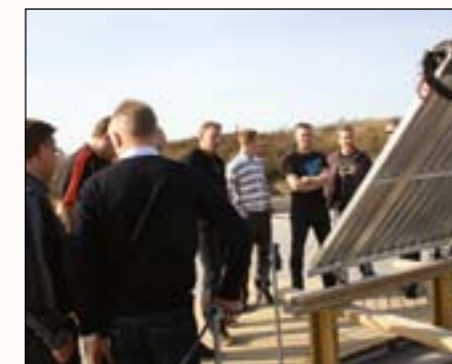
Figur 6 Eget prøveoppsett for solfangere på taket.
