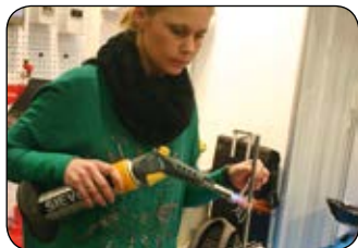
82 Aluminiumrør til installation af split-anlæg og varmepumper
