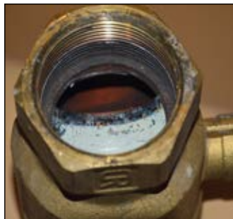
Et typisk eksempel på ventilhavari på grunn av korrosjon i anlegget. Her er det et anlegg som ikke har hatt tilsyn på mange år. Ventiler, pumper, og radiatorer blir spist opp dersom de ikke får den nødvendige service, mener CIM Norges Sture Ombler.
