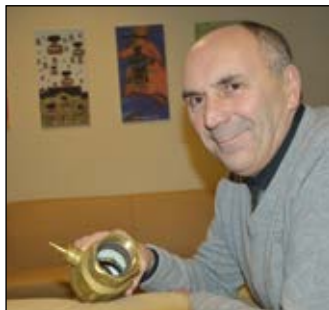
Et typisk eksempel på ventilhavari på grunn av korrosjon i anlegget. Her er det et anlegg som ikke har hatt tilsyn på mange år. Ventiler, pumper, og radiatorer blir spist opp dersom de ikke får den nødvendige service, mener CIM Norges Sture Ombler.
