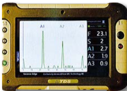
Med EDGE kan boreren følge boreprosessen på et display. Displayet gir boreren samtidinformasjon om hva som foregår nede i borehullet.
