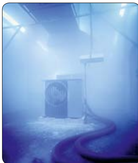
Test ved frostgrader i klimalaboratorium.
