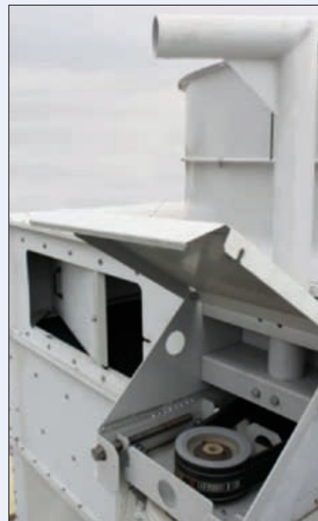
Fig. 2: Innoversleidet serviceluke. Motor med ekstern justering og daverer.
