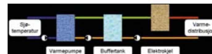
Varmeproduksjonen i anlegget er basert på varmepumper som grunnlast. Det vil bli nytta elektrokjeler som spisslast/reserve.
