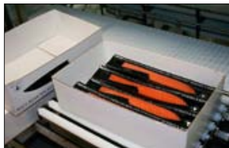
På Frøyas bruker man bølgepapp med tørris som D-pak i stedet for EPS-kasser med gel-is.
