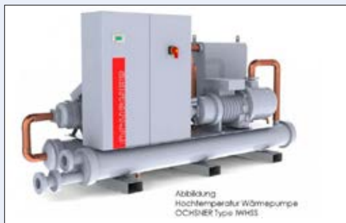
Høytemperatur varmepumper fra Ochsner med R134a i trinn 1 og naturlig kuldemiddel ÖKO 1 i trinn 2. Finnes for følgende nettspenninger; 230 Volt, 400 Volt og 3x230 Volt uten null.
