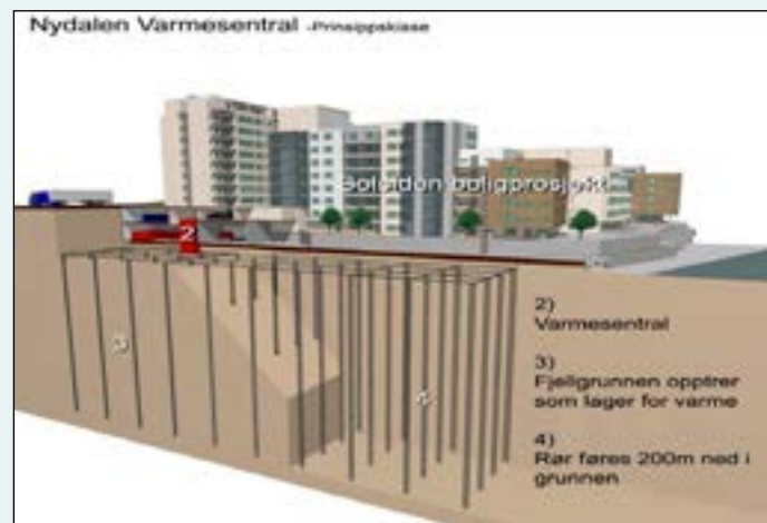
Avantor's bygg i Nydalen henter og leverer varme til grunnen ved hjelp av varmepumper; varme kan også dumpes i Akerselva ved stort kjølebehov.
