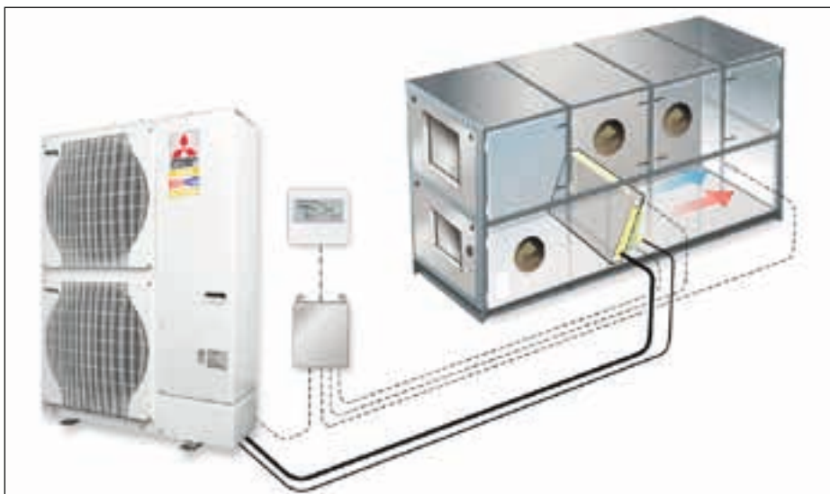
Ventilasjonskjøling/ varmepumpe er en energieffektiv måte å kjøle og varme ventilasjons- luften på (Illustrasjon Mitsubishi).
