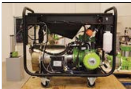
Inresols stirlingmotor kan gå døgnet rundt, og dessuten har stirlingmotoren høy virkningsgrad på lave omdreininger og lav belastning. (Foto: Jørgen Appelgren)
