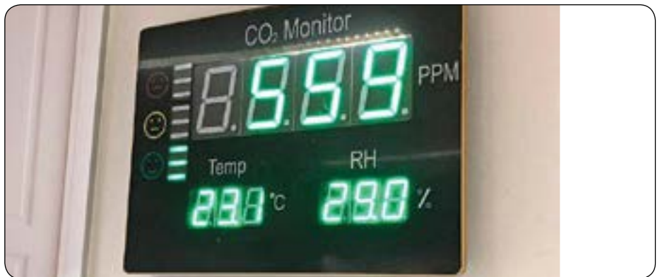
En monitor på væg viser CO 2 , temperatur og relativ fuktighed
