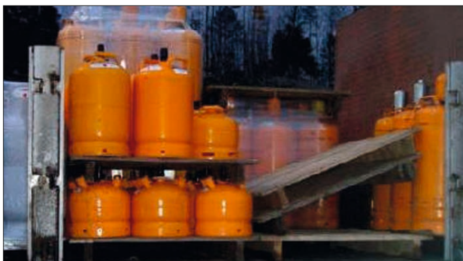
Vi tar også med et bilde fra Statens Vegvesen, som ikke har noe å gjøre med SRG, men som viser et virkelig skrekkelig bilde av uansvarlig transport av gassbeholdere.
