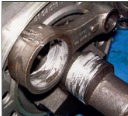
Her ser vi tegn på svejsning af aluminium fra plejlstangen på krumtapakslen. Dette sker, når kølemiddelvæsken fordamper fra olien og skyller smøringen af lejerne.
