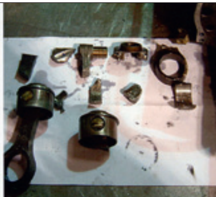
Billederne ovenfor viser omfanget af skaden som følge af væsketilbagestrømning. Læg mærke til størrelsen og mængderne af fragmenter fra de defekte plejlstænger og stempler på det første billede. På det andet billede ses tre defekte plejlstænger fra en maskine med fire cylindre, i begge tilfælde opstod skaden efter standsning af plejlstængerne på krumtapakslen.
