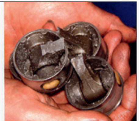
Billederne ovenfor viser omfanget af skaden som følge af væsketilbagestrømning. Læg mærke til størrelsen og mængderne af fragmenter fra de defekte plejlstænger og stempler på det første billede. På det andet billede ses tre defekte plejlstænger fra en maskine med fire cylindre, i begge tilfælde opstod skaden efter standsning af plejlstængerne på krumtapakslen.
