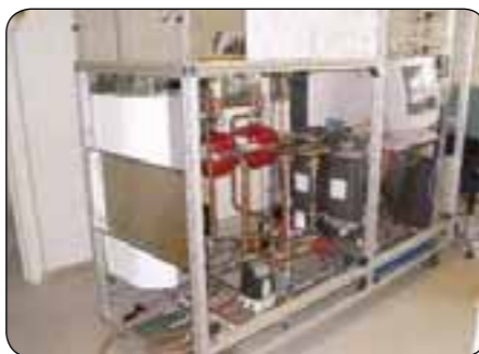
Højteknologisk, eksperimentelt kølesystem på Aalborg Universitet, sponsoreret af en række danske virksomheder. Det er koblet til internettet, så forskere kan lave eksperimenter uden at være fysisk til stede ved systemet. (Foto: AAU)
