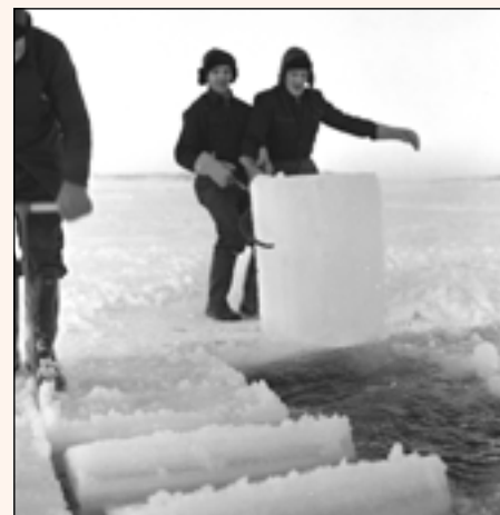
Bladet på de store issagene var ca. 1,5 m langt og måtte være nykvasset for at sagingen skulle gå fort. I enden av saga var det festet et ca. 2 kilos jernlodd som søkke.
