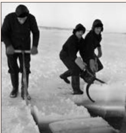
Man saget blokker på ca 150 - 200 kg., avhengig av tykkelsen på isen. Deretter løftet de den opp ved hjelp av isklippe/issaks.
