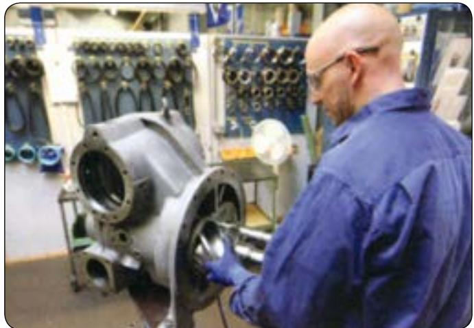
Øget energiforbrug pga. for tidlig slitage og ineffektiv drift vil øge driftsomkostningerne uforholdsmaessigt. Hvis et anlæg kan optimeres, så forskellen mellem fordampningstryk og kondensatortryk reduceres med 2-3 K, vil besparelserne kunne dække omkostningerne til service.
