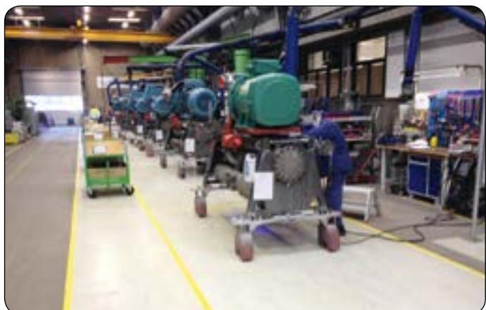
På produksjonslinjen flytter kompressorer seg fremover, mens man har alle nødvendige deler for hånden. Etter 14 dager er de forskjellige kompressorene ferdig produsert.
