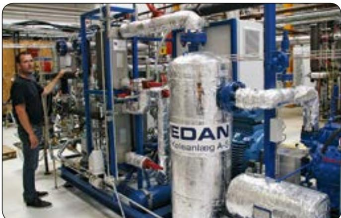
Et dansk PSO prosjekt omkring højeffektive ammoniak varmepumper. Prosjektet var bl.a. blandt de nominerede til "ELFORSK" prisene 2014, se [www.elforsk.dk](http://www.elforsk.dk). Der er i prosjektet utviklet en todelte kondensator, som sikrer ekstra høy fremlebstemperatur fra NH<sub>3</sub> varmepumpen samtidig med, at effektiviteten er forbedret ca. 20% ift. tradisjonelle systemer.
