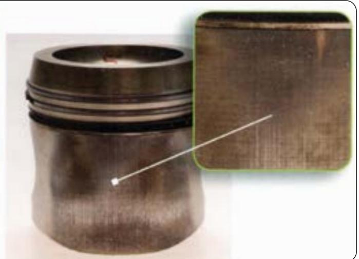
Til venstre: Stempel, Stempelringe uden overfladebehandling. Betydeligt slid på overfladen og slid på ring
