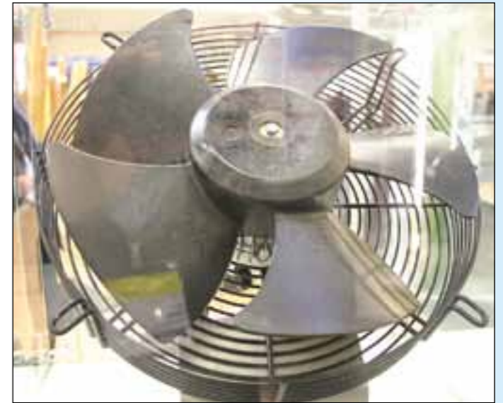
Nye viften er mer enn 60 % mer energieffektive enn de gamle viften.
