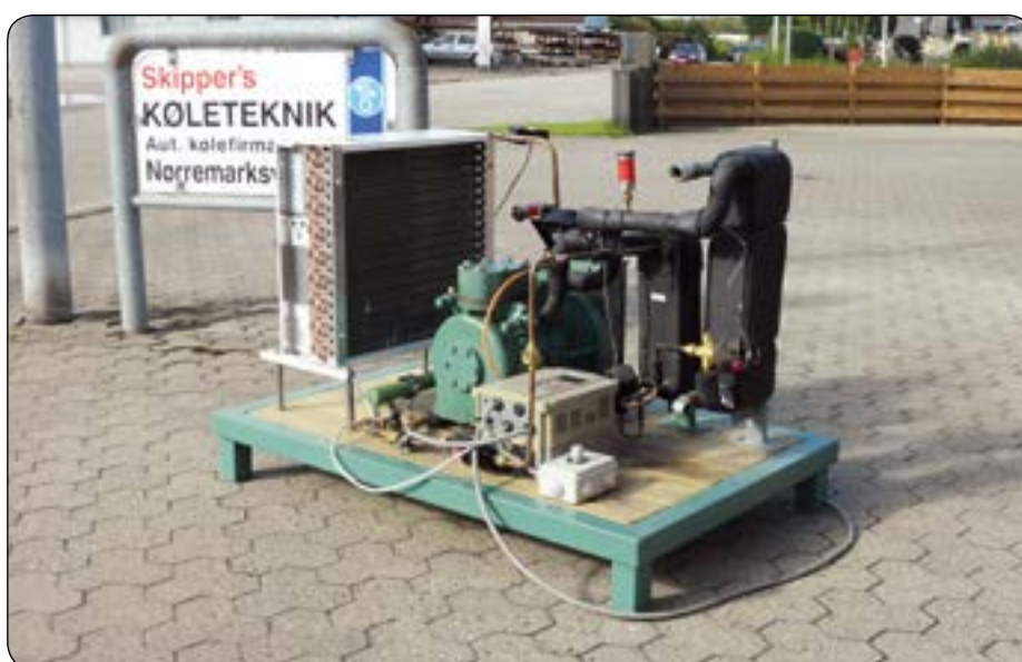
Prototypen er nu testet på Teknologisk Institut, som viser en forbedret køleydelse på 15 % og en bedre COP på 10%. Der skal dog videre udvikles på ventilen.
