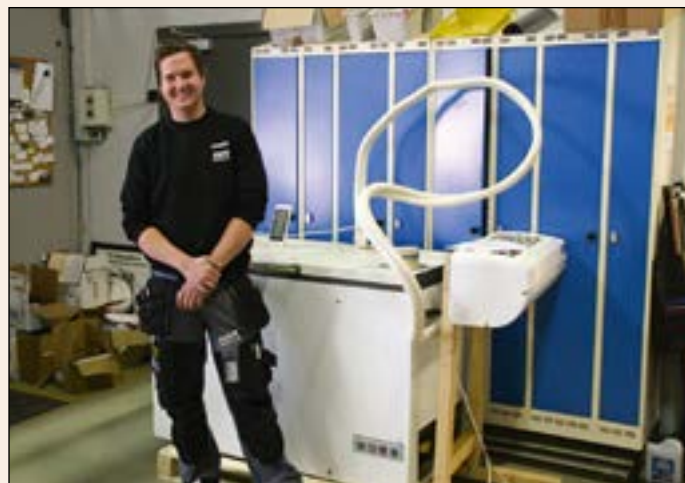
I dette prøveanlegget måler man varmepumpenes kapasitet under forskjellige forhold og driver med feilfinning.
