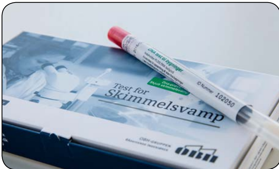
I mere end 1.000 ejendomme har ingeniørfirmaet OBH-Gruppen A/S nu anvendt DNA-baseret teknologi til at undersøge bygninger for fugtskader og skjult skimmelsvamp.
