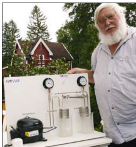
Demonstrasjonsmodellen, hvor man kan putte en finger i de to glassene med vann for å kjenne forskjellen på en kondensator med varme og en fordampere med kulde. Dette anskueliggjør kuldeanlegget på en god pedagogisk måte.
