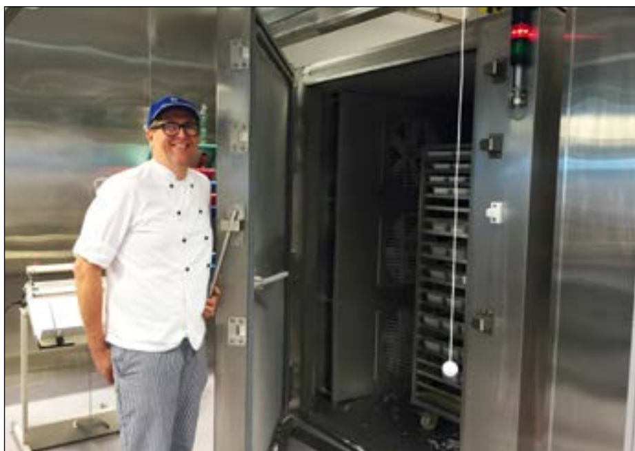
Fagkonsulent kvalitet i Drammen Kjøkken KF, Knut-Are Midtun foran nedkjølingsskapet hvor man cryokjøler maten med flytende nitrogen.
