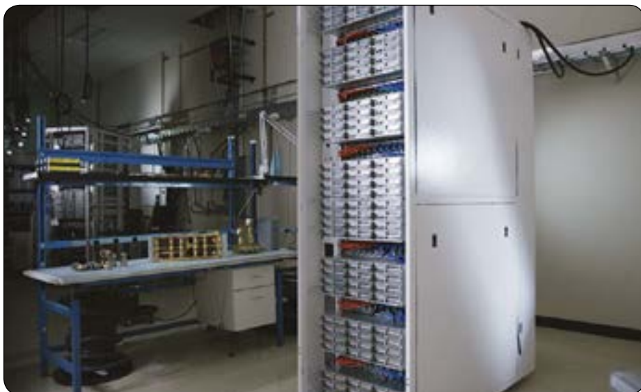
En testopstilling af et rack med Dells Triton-køling hos Dells udviklingsafdeling. Systemet skal nu afprøves i samarbejde med eBay. Foto: Dell
