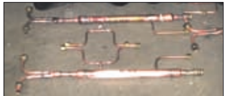
Loddeøvelsen gikk ut på å lage en sugegassvarmeveksler
