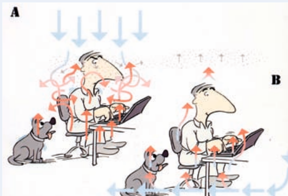
A Omblandingsventilasjon. B Fortrengningsventilasjon.
