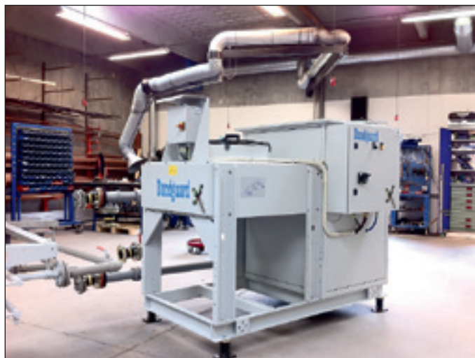
Luftkølet vandkøleanlæg fra Bundgaard Køleteknik A/S med det miljøneutrale kølemiddel R290 Propan. Anlægget er på ca. 15 kW med semihermetisk stempelkompressor, pladeveksler, luftkølet kondensator mm. Desuden også med frikøler. Anlægget er forberedt for opsætning og tilslutning ved kunden. Inkl. el tavle og vibrationsdæmpende fødder.
