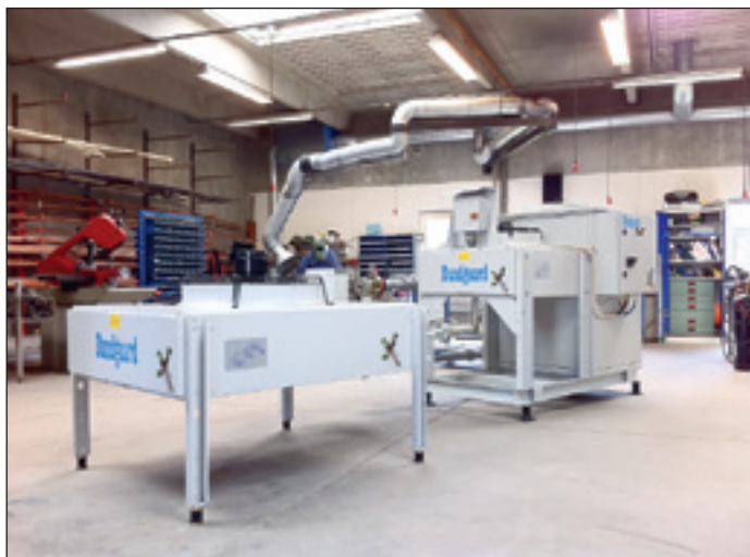
Luftkølet vandkøleanlæg fra Bundgaard Køleteknik A/S med det miljøneutrale kølemiddel R290 Propan. Anlægget er på ca. 15 kW med semihermetisk stempelkompressor, pladeveksler, luftkølet kondensator mm. Desuden også med frikøler. Anlægget er forberedt for opsætning og tilslutning ved kunden. Inkl. el tavle og vibrationsdæmpende fødder.
