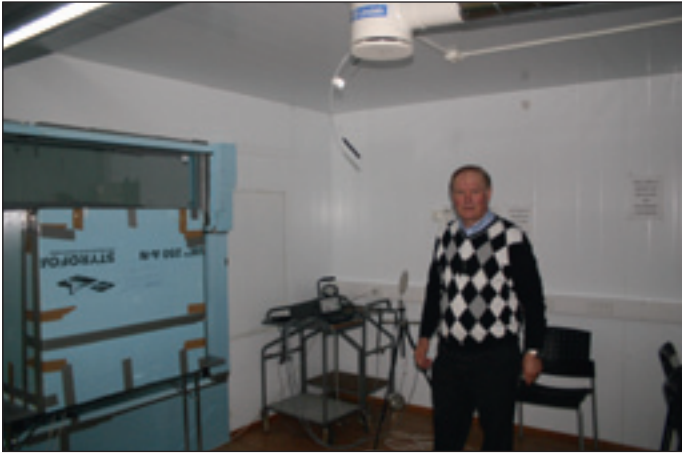
Fra inneklimarammet hvor man kan oppnå "utetemperaturforhold" ned til minus 30 kuldegrader på den andre siden av veggen.
