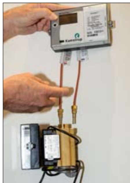
Varmemaalreren er en av to nøkler til enkle COP-måling av varmepumpen.
