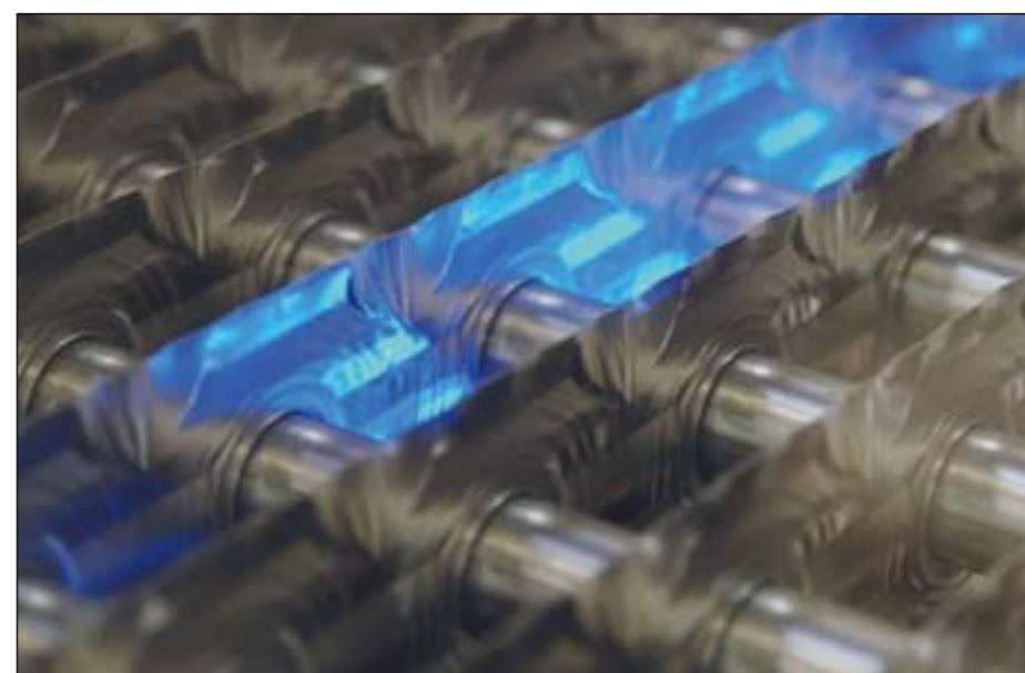
Ovnloddet varmeveksler med AIMPE rør og Al finner.
