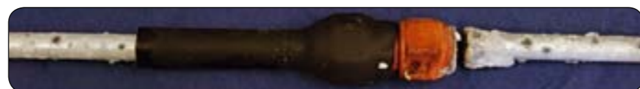
Korrosionstesting i søvannsmiljø etter 40 timer. Venstre del med krympeflex over selve samlingen og højredel uden.
