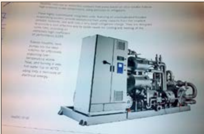
Figur 4: Ammoniakkbasert varmepumpe med høytrykks skruekompressor. Godt egnet til å utnytte lavtemperatur spillvarme for å produsere varmt vann opp til 90° C.
