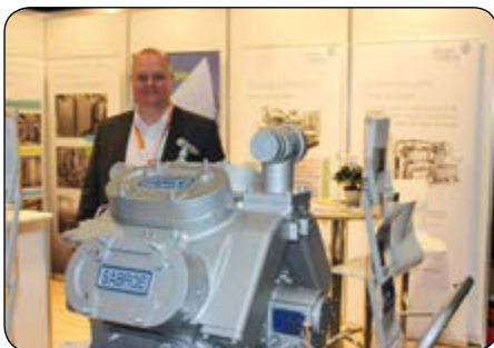
Klavs Damgaard fra Johnson Controls viste frem den nye ammoniakk varmepumpen HPC 70 som kommer neste år. Den har en kapasitet 600 kW og en temperatur på hele +90 grader. Kompressoren leveres med 4, 6 og 8 sylindre.
