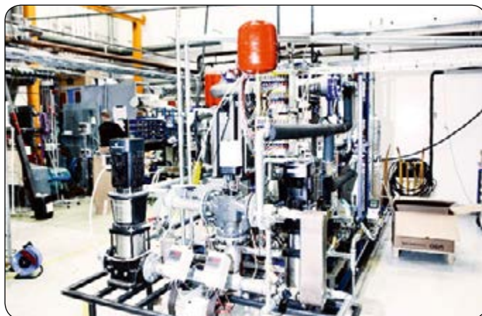
Projektet 'Energieffektiv ammoniak varmepumper', som omhandler et højtryks ammoniak anlæg med splitkondensering, var blandt de fire nominerede til årets Elforsk pris.
