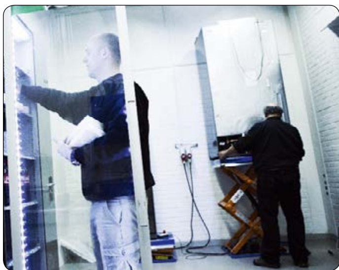
I Energilaboratoriet udfører man forskellige prøvninger af professionelle og kommercielle kølemøbler efter gældende, men også kommende standarder.
