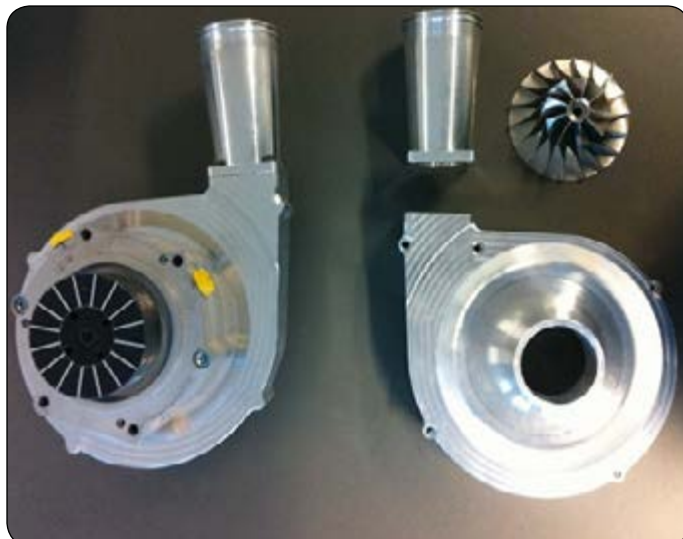
Udviklingsprojektet med Rotrex resulterede i udviklingen af turbokompressorer for kompression af varm damp, der nu langtidstestes.
