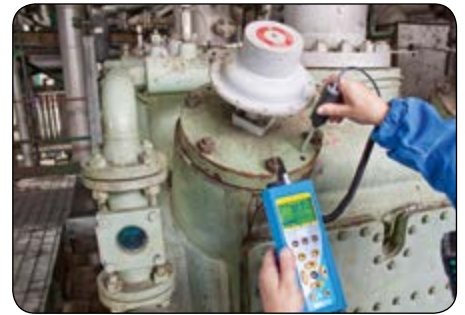
Med ultralydsmålere opfanges uregelmæssigheder og mislyde.
