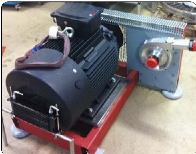
Udviklingsprojektet med Rotrex resulterede i udviklingen af turbokompressorer for kompression af varm damp, der nu langtidstestes.
