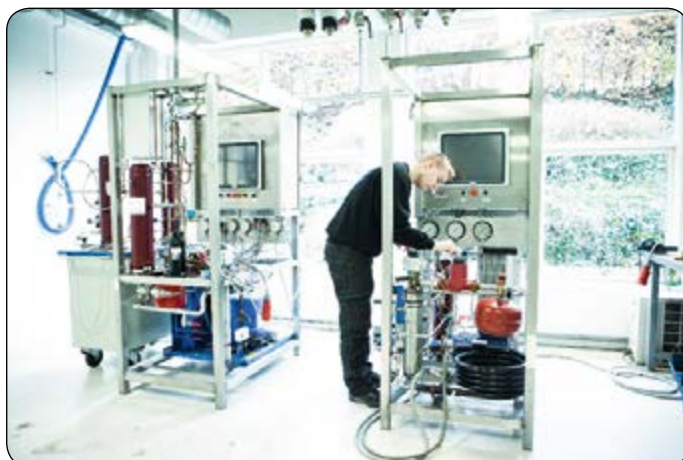
\text{CO}_2 anlæg, som bruges i forbindelse med undervisningen på Teknologisk Institut. Der er også mulighed for praktisk erfaring med undervisningsanlæg med ammoniak.
