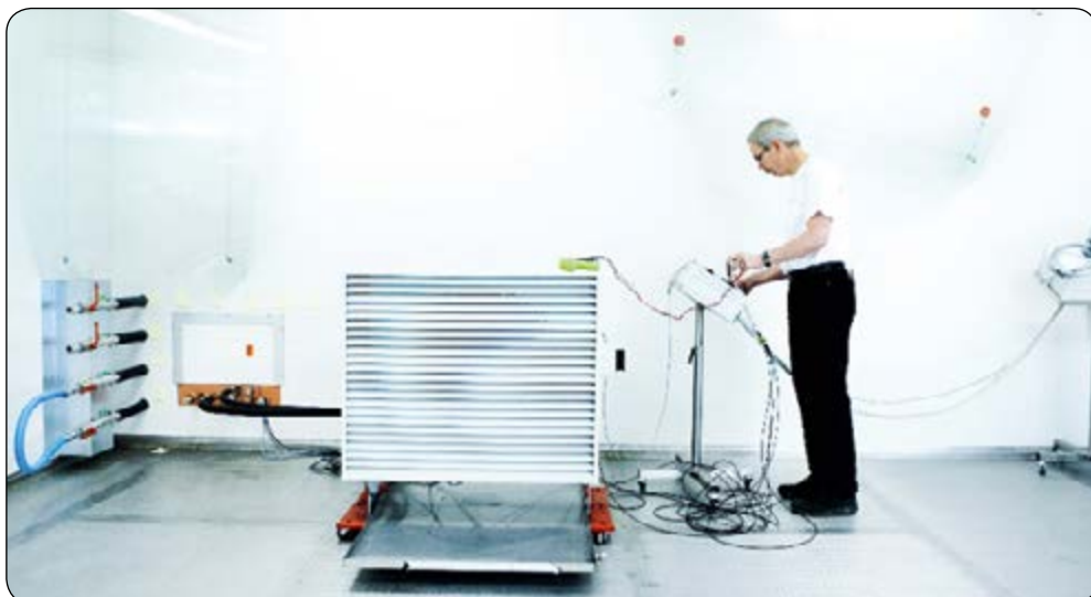
Siden indvielsen af varmepumpetestcentret sidste år er der bl.a. udført SCOP prøvning på mere end 50 varmepumper og lydmåling på en række varmepumper.
