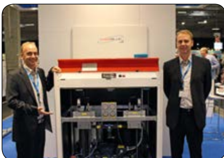
Ahlsell var på plass med Michael Rasmussen og Henrik Mogensen som viste sin nye vand-vand CO 2 varmepumpe som sikrer 500 til 3000 liter vand pr time af op til 90 grader Celsius. Den har intelligent parallellstyring af op til 4 enheder og med muligheder for kølegenvinding.
