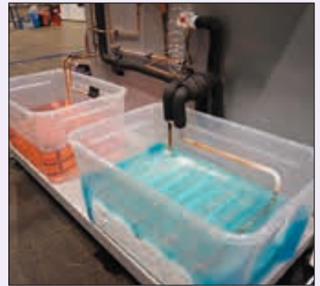
Hovedoppgave var å bygge et komplett kuldeanlegg, som skulle henholdsvis fryse et basseng med vann og varme et basseng med vann
