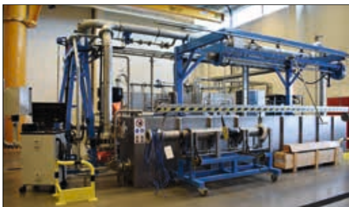
Grundfos Norges nye testrigg for pumper har en 'hjerne' som utfører alle tester og funksjoner og gir helt nye muligheter. Riggens tester alle pumpetyper og merker.
