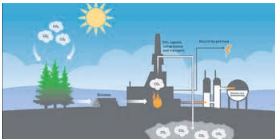
Bio-CCS er å ta ut CO 2 fra klimanøytrale energiprosesser, og lagre den under jorda. Da fjerner man i praksis denne CO 2 -en fra atmosfæren. Derfor kalles metoden karbonnegativ teknologi. Illustrasjon: Doghouse.no
