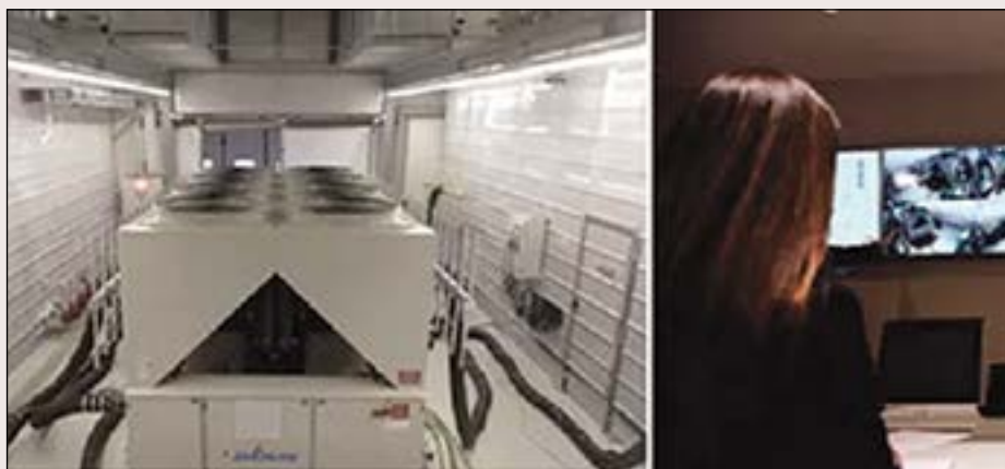
Med det siste innenfor teknologi kan Daikin teste vannkjølte og luftkjølte maskiner i både kjøle- og varmedrift under ekstreme driftsforhold.
